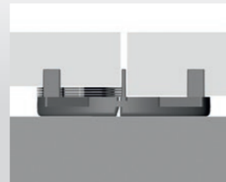
Verlegen von unterschiedlichen Plattenstärken
